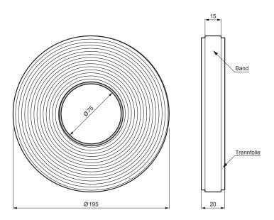
Das doppelseitige Butylband Eurovent BUTYL ist zum Verbinden und Abdichten von Dampfsperrfolien, Dachmembranen, Fundamentfolien und anderen Bauprodukten auf Kunststoffbasis vorgesehen. Hergestellt auf Butylbasis, ohne Lösungsmittel, durch eine Folienschicht geschützt.
