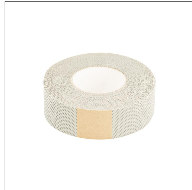
Einseitiges Band aus Polypropylen-Vlies- und Acryl-Dispersionskleber. Vorgesehen für Abdichtung und Reparatur von Dachmembranen und anderen Baumaterialien auf Polypropylenbasis. Das Band schützt gegen Eindringen von Feuchtigkeit und Wind und behält dabei die Dampfdurchlässigkeit der Membran, deren Oberfläche atmet.
