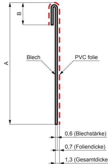
**BLECH MIT PVC** ist ein beidseitig feuerverzinktes Blech mit laminierter PVC-Folie in Farbe auf der Vorderseite und mit einer Decklackierung auf der Rückseite. Laminiertes Blech wird nach STN EN 10169+A1 und STN EN 14783 hergestellt.
