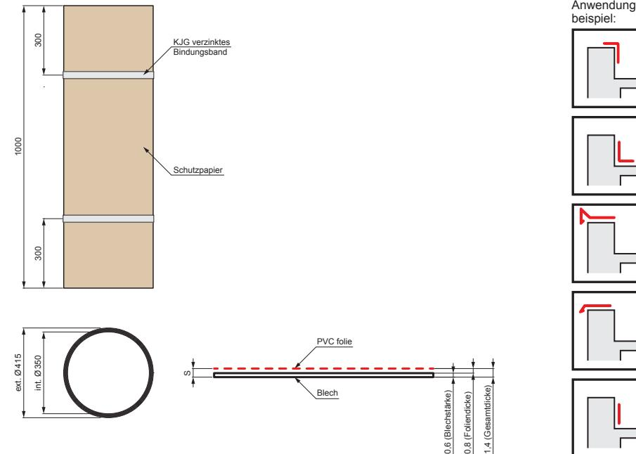
**BLECH MIT PVC** ist beidseitig feuerverzinktes Blech mit laminierter PVC-Folie in der Farbe auf der Vorderseite und dem Decklack auf der Rückseite.
