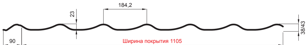
L – ОПТИМАЛЬНАЯ ДЛИНА ПОКРЫТИЯ ДЛЯ МОДУЛЯ 350 mm
