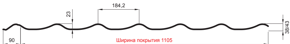
L – ОПТИМАЛЬНАЯ ДЛИНА ПОКРЫТИЯ ДЛЯ МОДУЛЯ 350 mm
