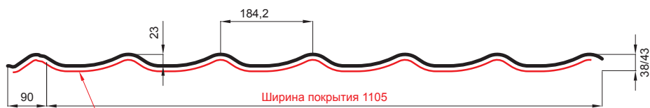
L – ОПТИМАЛЬНАЯ ДЛИНА ПОКРЫТИЯ ДЛЯ МОДУЛЯ 350 mm
