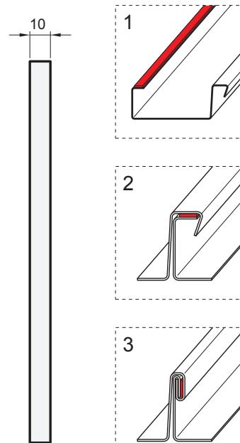
Использование уплотнительной ленты в двойной вертикальной канавке
