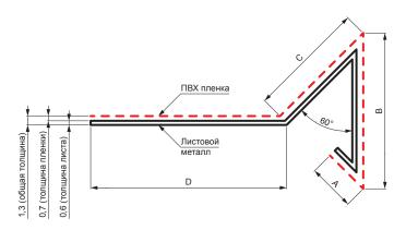
**ЛИСТ С ПВХ** представляет собой двусторонний горячеоцинкованный лист плотностью 275 г/м² с ламинированной цветной ПВХ-пленкой на лицевой стороне и с верхним покрытием лаком на оборотной стороне. Ламинированный лист производится в соответствии со стандартами STN EN 1849-1, STN EN 1297 и STN EN 4102.
