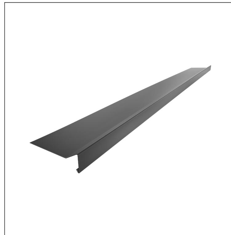
**ЛИСТ С ПВХ** представляет собой двусторонний горячеоцинкованный лист плотностью 275 г/м<sup>2</sup> с ламинированной цветной ПВХ-пленкой на лицевой стороне и с верхним покрытием лаком на оборотной стороне. Ламинированный лист производится в соответствии со стандартами STN EN 1849-1, STN EN 1297 и STN EN 4102.
