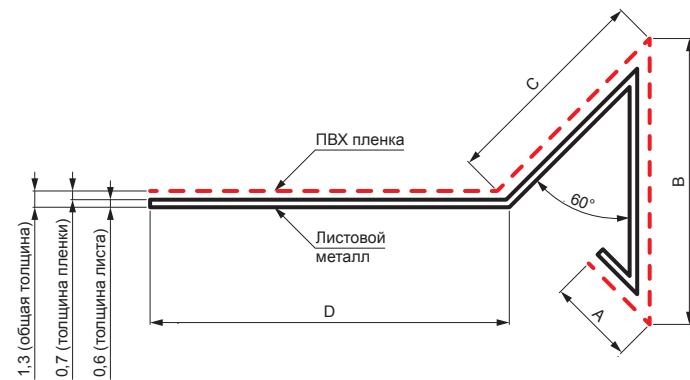
**ЛИСТ С ПВХ** представляет собой двусторонний горячезинкованный лист плотностью 275 г/м<sup>2</sup> с ламинированной цветной ПВХ-пленкой на лицевой стороне и с верхним покрытием лаком на обратной стороне. Ламинированный лист производится в соответствии со стандартами STN EN 1849-1, STN EN 1297 и STN EN 4102.
