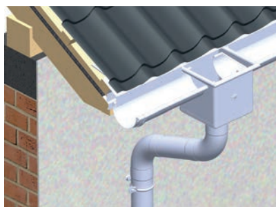
1. Spôsob montáže kotlíka zberného
